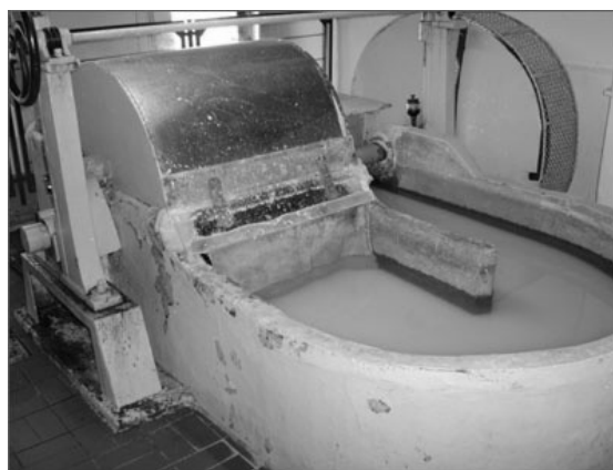
Holender - urządzenie do produkcji masy papierniczej poprzez mielenie włókien celulozowych. Pierwsza konstrukcja pochodzi z 2 połowy XVII w. (Muzeum Papiernictwa w Dusznikach Zdroju)
