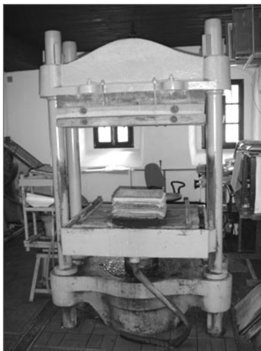
Prasa hydrauliczna do odciskania wody z papieru (Muzeum Papiernictwa w Dusznikach Zdroju)
